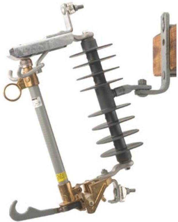
*Si a la palanca se le da un tirón energético hacia abajo con una pértiga, se causa la apertura en el fusible. (Se ilustra el producto de 15/27 kV)*
