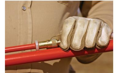
Accesorio universal de fábrica en el extremo opuesto al cabezal de la pinza de sujeción.
