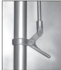
El gatillo al final de la varilla de operación controla el rodillo para abrir y cerrar las mandíbulas del amperímetro.
