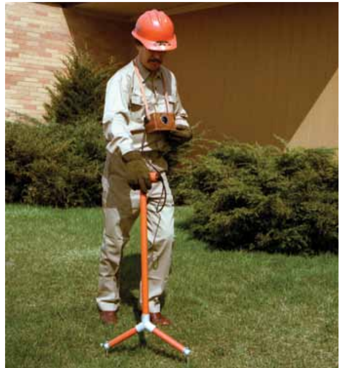
Localización de la falla.
