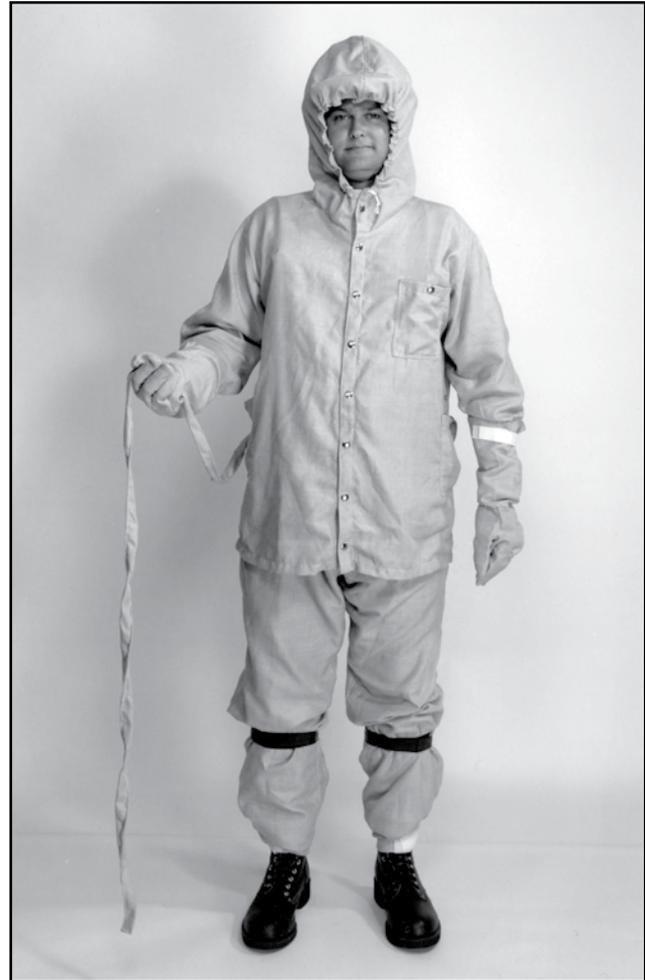
Este traje conductivo de dos piezas, para trabajar con tensiones de hasta 765 kV, está hecho de una mezcla de fibra aramídica Nomex resistente a las llamas y fibras microscópicas de acero inoxidable. Se le aplica una capa de Zepel para repeler el agua. Las pruebas y análisis demuestran que el material:
