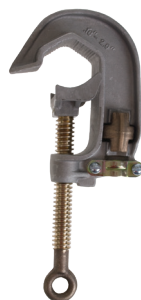
C6002282 Cuerpo de aluminio, mordazas dentadas, perno de ojo de bronce con rosca Acme terminal de bronce a presión
