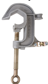
C6002255 Cuerpo de aluminio, mordazas lisas, perno de ojo de bronce con rosca Acme, terrajado para casquillo roscado UNC de 5/8-11 *Solo casquillos sin protección
