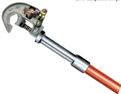
C6000386 *Grapa montada Cuerpo de aluminio, mordazas dentadas, perno de ojo de bronce con rosca Acme, terminal de bronce a presión
