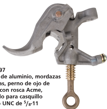
C6001757 Cuerpo de aluminio, mordazas lisas, perno de ojo de bronce de rosca fina, terrajado para casquillo roscado UNC de 5/8-11
