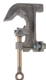
T6000658 Cuerpo de aluminio, mordazas lisas, perno de ojo de bronce con rosca Acme, taladrado para casquillo roscado UNC de 5/8-11
