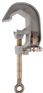
C6002281 Cuerpo de aluminio, mordazas lisas, perno de ojo de bronce con rosca Acme, terminal de bronce a presión
