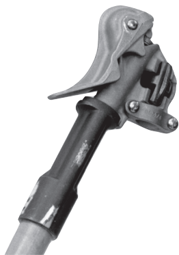
HG37061 *Grapa montada Cuerpo de aluminio, mordazas lisas, perno de ojo de bronce de rosca fina, terminal de bronce a presión
