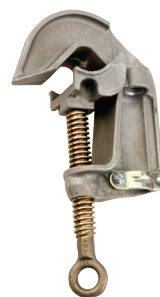
T6003203 Cuerpo de aluminio, mordazas lisas, perno de ojo de bronce con rosca Acme, terrajado para casquillo roscado UNC de 5/8-11 *Solo casquillos sin protección
