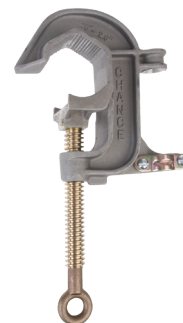
C6002256 Cuerpo de aluminio, mordazas dentadas, perno de ojo de bronce con rosca Acme, terrajado para casquillo roscado UNC de 5/8-11 *Solo casquillos sin protección
