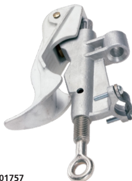
C6001757 Cuerpo de aluminio, mordazas lisas, perno de ojo de bronce de rosca fina, terrajado para casquillo roscado UNC de 5/8-11
