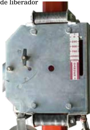
El adaptador de la pluma puede fijarse en diversos ángulos. Una balanza incorporada verifica continuamente la elevación de la carga. Los rodillos de nylon aseguran un desplazamiento suave sobre el mástil.
