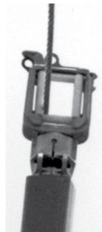
El soporte de conductor central, usado solo, permite levantar una fase.
