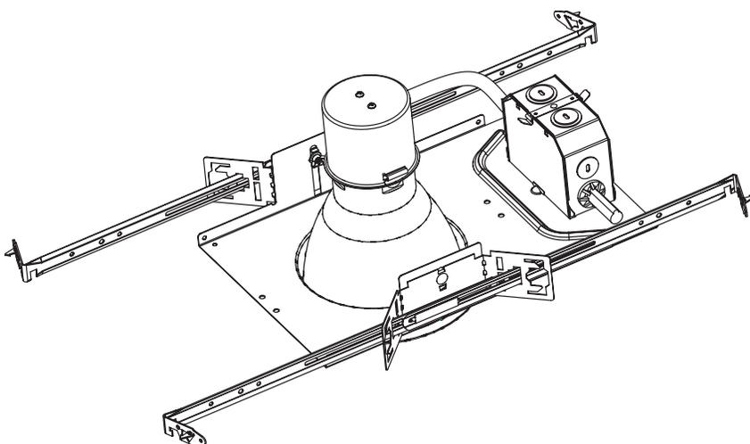
1. Retirez les barres de suspension et les supports et réinstallez-les comme illustré. Installez le luminaire au plafond en vous servant des barres de suspension (fournies), du montant ou de la barre de suspension (non compris) placés dans les supports de montage réglables. Installez le luminaire au plafond de sorte que le poids de l'appareil soit supporté par les barres de suspension, par le montant ou la barre de suspension, ou par les fils de suspension fixés à la structure du bâtiment.
