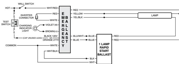
FIG B ONE (1) LAMP INSTANT START BALLAST
