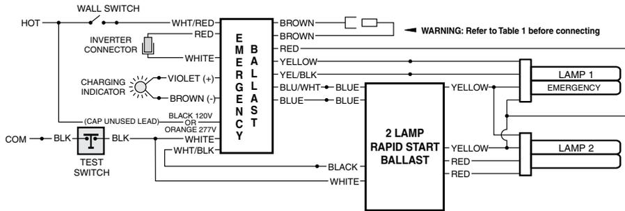
**EMERGENCY BALLAST AND AC BALLAST MUST BE FED FROM THE SAME BRANCH CIRCUIT**
