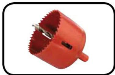
Utilisez une scie-cloche de 2,3 cm (2 7/8 po) et percez un trou d'implantation pour faire une ouverture pour le plafonnier intensif D2LED. En raison de la petite taille de la bride du réflecteur du D2LED, la précision de l'ouverture est essentielle. Même une scie-cloche de 7,6 cm (3 po) peut laisser une ouverture au plafond trop grande pour être entièrement cachée après l'installation.
