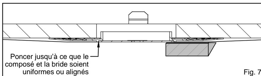
8. Une fois que le composé pour cloison sèche a complètement durci, le plafond peut être peint. Lorsque la peinture est sèche, retirer le bouchon de plâtre et tout autre composé de plâtre ou peinture qui pourrait s'être infiltré près du bouchon de plâtre en grattant soigneusement au besoin.
