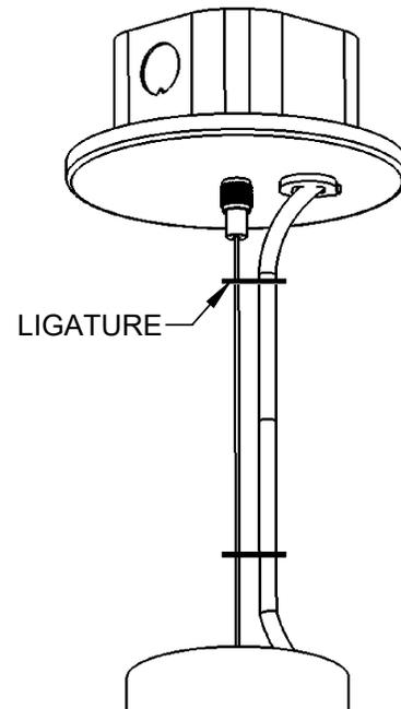
7. PLACER LES RACCORDEMENTS DE CÂBLAGE DANS LA BOÎTE DE JONCTION ET REFIXER LA ROSACE CONTRE LE PLAFOND À L'AIDE DU COUPLEUR TUBULAIRE.
