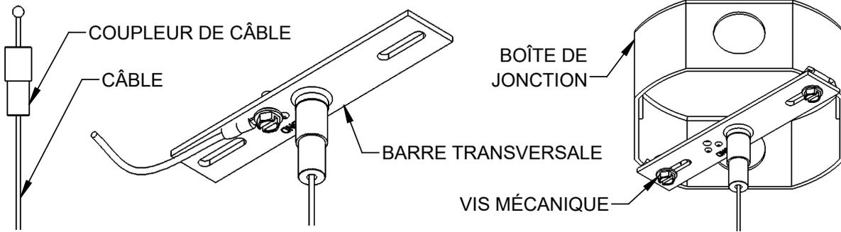
1. TIRER LE CÂBLE À TRAVERS LE COUPLEUR DE CÂBLE ET L'ATTACHER À LA VIS DE LA BARRE TRANSVERSALE.
