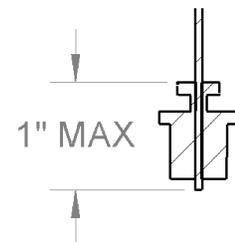
4. ATTACHER L'EXTRÉMITÉ INFÉRIEURE DU CÂBLE AU LUMINAIRE EN DESSERRANT LE CONTRE-ÉCROU SUR LE SERRE-CÂBLE AVANT DE TIRER LE CÂBLE ET DE RESSERRER LE CONTRE-ÉCROU. LA LONGUEUR DE CÂBLE DANS LE SERRE-CÂBLE NE DOIT PAS DÉPASSER 2,5 CM (1 PO).
