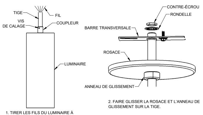
1. TIRER LES FILS DU LUMINAIRE À TRAVERS LA TIGE, VISSER LA TIGE DANS LE COUPLEUR ET LA FIXER À L'AIDE DE LA VIS DE CALAGE.
