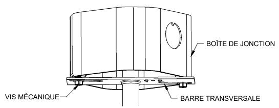
4. FIXER LA BARRE TRANSVERSALE À UNE BOÎTE DE JONCTION OCTOGONALE DE 10 CM (4 PO), NON FOURNIE, À L'AIDE DE (2) VIS MÉCANIQUES N° 8-32, NON FOURNIES. 5. SI LA LONGUEUR DU FIL DÉPASSE DE 15,2 CM (6 PO) AU-DESSUS DE LA BARRE TRANSVERSALE, COUPER L'EXCÉDENT, DÉNUDER LES CONDUCTEURS SUR 0,9 CM (3/8 PO) ET RÉÉTIQUETER LES FILS DE GRADATEUR. EFFECTUER LES RACCORDEMENTS ÉLECTRIQUES. POSER DES CAPUCHONS SUR LES FILS DE GRADATEUR INUTILISÉS.
