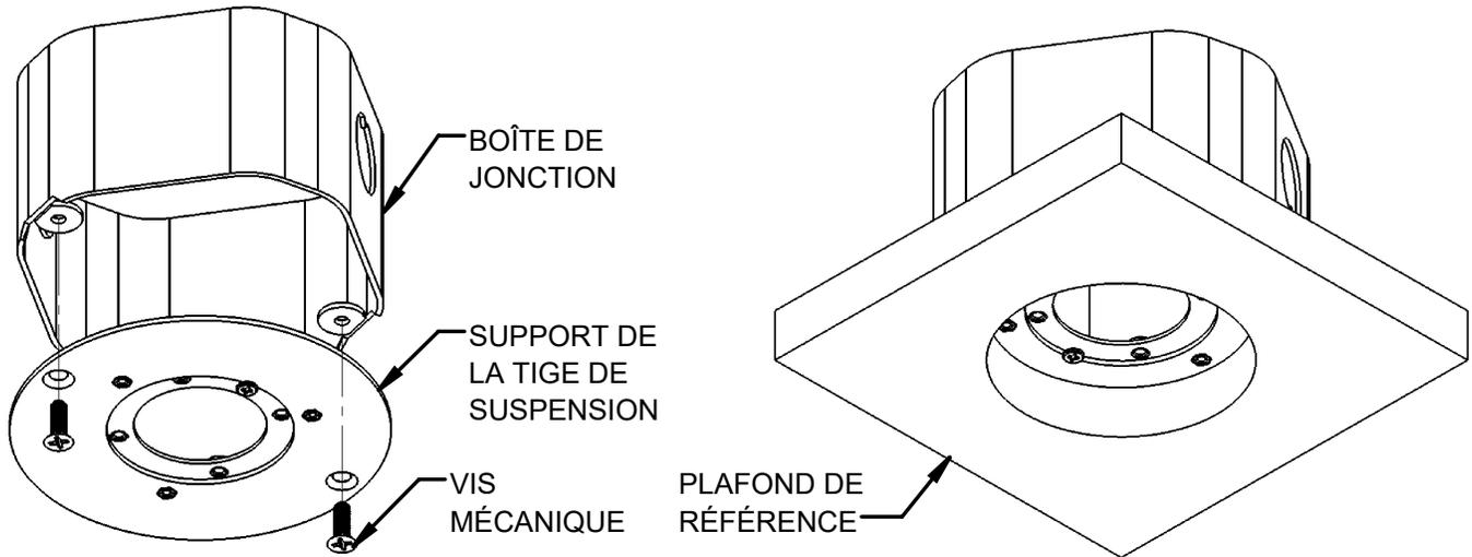
1. FIXER LE SUPPORT DE LA TIGE DE SUSPENSION À UNE BOÎTE DE JONCTION OCTOGONALE DE 10 CM (4 PO), NON FOURNIE, À L'AIDE DE VIS DE MÉCANIQUE À TÊTE FRAISÉE N° 8-32.
