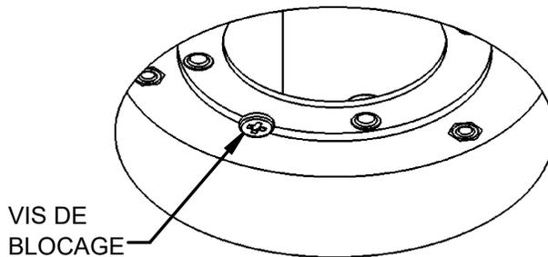
3. VERROUILLAGE DU SUPPORT DE LA TIGE DE SUSPENSION :
