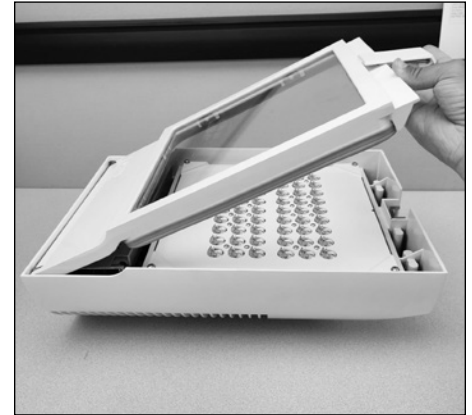
15. Re-hang door frame.
