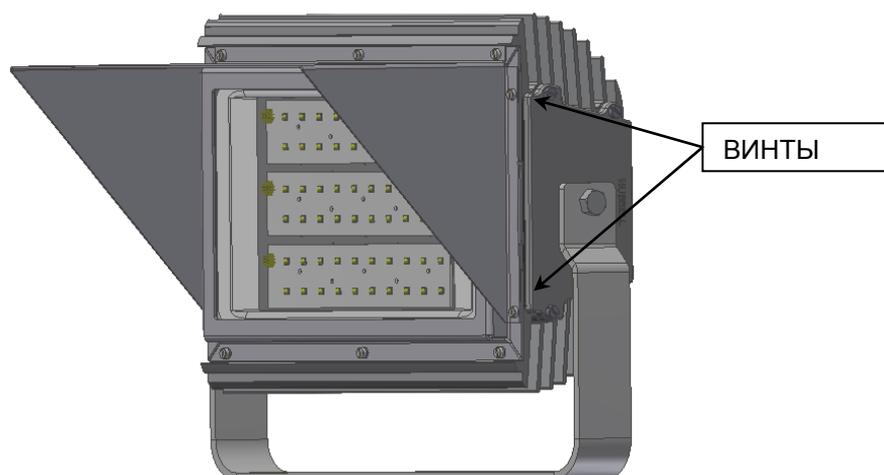
Для установки щитка на узел линзы убедитесь, что светильник полностью в собран. Установите щиток на узел линзы, введя в зацепление выступы на щитке с выступами на корпусе светильника. Проверьте надежность установки.
