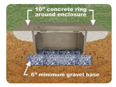
AROUND BOX 10 6 **QUAZITE® BOX & COVER** 6 COMPACTED EARTH **IN COMPACTED EARTH** ASPHALT PAVEMENT CONCRETE RING AROUND BOX **QUAZITE® BOX & COVER** 6 4 6 **IN ASPHALT PAVEMENTS** CONCRETE PAVEMENT D QUAZITE<sup>®</sup> BOX & COVER D D -4
