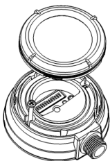
Lens installation Installation de la lentille Instalación del lente
