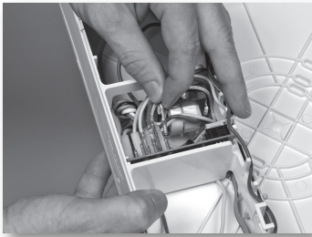
Disconnect lamp leads at the printed circuit board. Desconecte las cabezas de lámpara en la placa de circuitos impresos.
