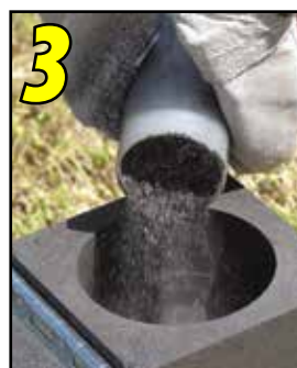
Pour powder into crucible.
