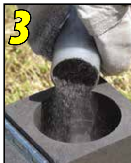
Pour powder into crucible.
