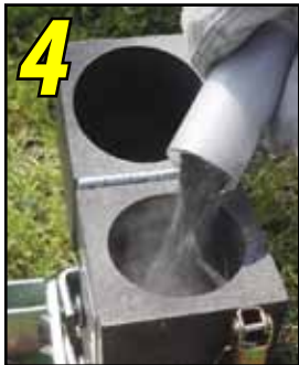
4 Pour powder into crucible.
