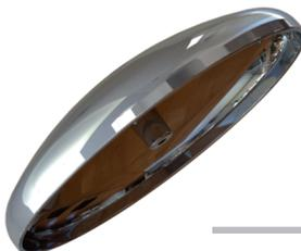
**Calotas anti-corona** fabricado em liga de alumínio fundido, as calotas anti-corona protegem do efeito RIV/Corona e são necessários quando os equipamentos não estão protegendo a conexão. Esse modelo permite rápida instalação.
