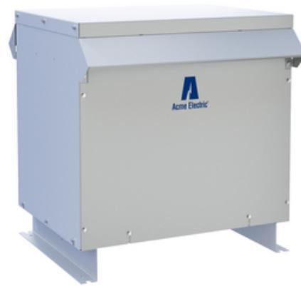
Transformateur de charge non linéaire - triphasé, 480Δ - 208Y/120V, 112,5kVA, K13, élévation 115°C.
