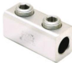
Épissure mécanique en aluminium, 250 kcmil-6 AWG, diamètre de vis 5/8", 4 vis, taille d'hexagone 5/16", revêtement Al/Cu, étamé.
