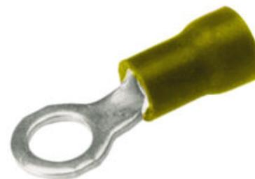
Borne Cu, en vrac, languette annulaire, fils #12 - #10 AWG, 600 V, goujon 3/8", isolée au polychlorure de vinyle, jaune.
