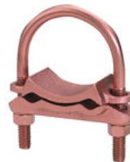
Connecteur de mise à la terre mécanique, 2 câbles parallèles à la tige ou au tuyau, 4 AWG ( Sol.) - 2/0 AWG (Str.), tige de 3-1/2" à 4", tuyau de 3-1/2".
