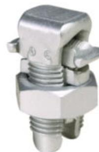
Boulon à tête fendue en aluminium, (coulé, taraudé): : Al-Al : 4/0 AWG (Str), 4/0 AWG (Str) , Al-Cu : 2 AWG (Str), 6 AWG (Str) , Cu-Cu : 4/0 AWG (str), 6 AWG (str), étamé.
