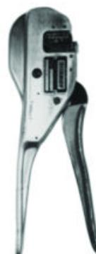
Sertisseuse à cliquet à cycle complet, applications critiques, connecteurs #22-10 AWG YAV, T, YAD.
