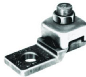
Borne en alliage à haute teneur en cuivre, usage intensif, 1 trou, 3/0 - 4/0 str. commercial, 150 - 200 Navy, 1 vis, étamage à chaud, 0.41" Dia. du trou
