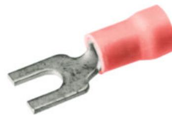
Borne en cuivre à languette à fourche, 22-16 max. Dia. Dia. Accom. : .145 Code couleur : Rouge, 8-10, .95 in L, .41 in W, Isolation en polychlorure de vinyle.
