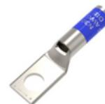
5 AWG CU, un trou, taille de goujon 1/4, canon standard, fenêtre d'inspection, chanfrein interne, étamé, UL/CSA 90° jusqu'à 35kV, code couleur BLEU, indice de matrices 7 ou 374.
