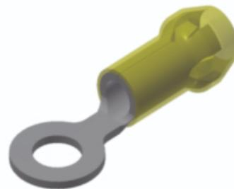
Cosse en cuivre, languette annulaire, 1 trou avec trou d'inspection, 12-10 AWG, goujon #4-#6, isolée, canon court, étamée.
