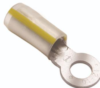
Borne à anneau résistante aux radiations et aux températures élevées. Borne annulaire, cuivre pur, entrée lisse en entonnoir, avec fenêtre d'insertion, 10-12 AWG, 600 V, goujon #10, isolant en polyvinylidène, joint brasé.
