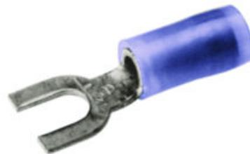
Borne en cuivre isolée nylon, languette à fourche, #16 - #14 AWG, 300 V, goujon #8 - #10, longueur de bande 7/32 IN.
