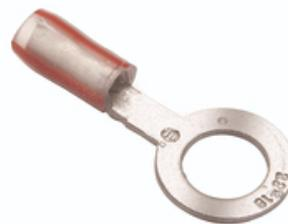
Borne à anneau résistante aux radiations et aux températures élevées. Anneau de raccordement, cuivre pur, entrée en entonnoir lisse, avec fenêtre d'insertion, 18-22 AWG, 600 V, goujon 1/4", isolant en polyvinylidène, soudure par brasage.
