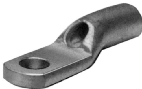
Cosses à compression en cuivre, usage intensif, languette annulaire, 1 trou avec trou d'inspection, 12-10 AWG/ 14 AWG(Str), goujon #4-#6, canon court, étamées.
