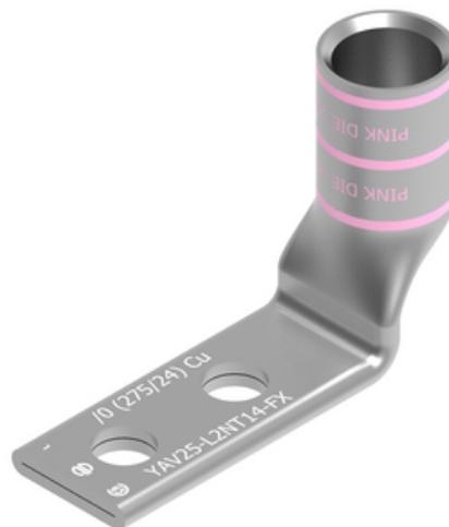
Cosses à compression en cuivre, languette étroite, 2 trous avec fenêtre d'inspection, 1/0 AWG, goujon 1/4", 12 index, rose, étamé, 90 degrés.
