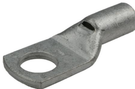
Cosses à compression en cuivre, usage intensif, languette annulaire, 1 trou avec trou d'inspection, AN-1/0 Flex, goujon 1/2", canon court, étamées.
