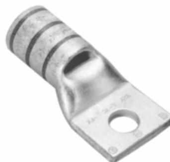
2/0 Flex G,H,I,K,M,DLO, 2/0 AWG CU, un trou, taille de goujon 5/16, canon standard, fenêtre d'inspection, chanfrein interne à languette étroite, étamé, UL/CSA, 90°C, jusqu'à 35kV, code couleur noir, indice de matrices 13.
