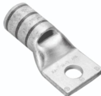
Cosse en cuivre, languette annulaire, 1 trou avec trou d'inspection, AN-2 Flex, goujon 1/4", canon court, étamé, 1.72" L max.
