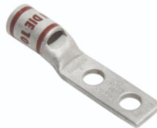
2 Flex G,H,I,K,M,DLO, 2 AWG CU, deux trous, taille de goujon 1/4, espacement de 1 trou, canon standard, fenêtre d'inspection, languette étroite, chanfrein interne, étamage, UL/CSA, 90°C, jusqu'à 35kV, code couleur marron, indice de matrices 10.
