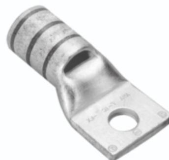
Cosses à compression en cuivre, languette annulaire, 1 trou avec trou d'inspection, AN-2 Flex, goujon #10, canon court, étamées.
