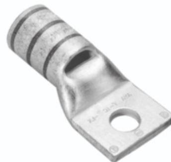
Cosses à compression en cuivre, languette annulaire, 1 trou avec fenêtre d'inspection, AN 4 Flex, goujon 3/8", canon court, étamées.
