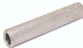
Réducteur en aluminium, conçu pour joindre (i) Cu à Alum. ou ACSR (ii) Alum ou ACSR à Alum. ou ACSR, barils partiellement remplis de PENETROX™ et scellés.
