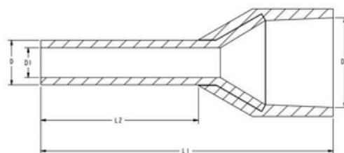
Les ferrules sont des connecteurs électriques utilisés pour terminer les fils torsadés, créant une connexion fiable et de qualité en s'assurant que chaque fil conduit le courant lorsqu'il est correctement serti. Ils sont particulièrement utiles lorsque des reconnections multiples peuvent être nécessaires dans des blocs de jonction ou d'autres dispositifs similaires.
