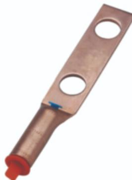
Borne à compression en cuivre HYLUG™ pour mise à la terre ; 2 trous ; goujon de 1/2" ; espacement de 1-3/4" ; baril long ; convient à 500 kcmil ; 5,94" de longueur : 500 kcmil ; 5.94" Longueur.
