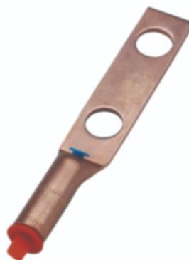
Borne à compression en cuivre HYLUG™ pour mise à la terre ; 2 trous ; goujon de 1/2 po ; espacement de 1-3/4 po ; baril long ; convient aux câbles de 6 AWG : #6 AWG.
