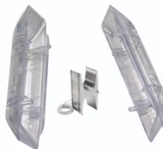
Taraud en cuivre à compression en H, étamé, compatible avec les tailles de fils suivantes - Courant (principal) : 750 KCMIL-500 KCMIL Classe B,C, 535 KCMIL-444 KCMIL DLO, 550-450 KCMIL Classe I, Robinet 1 : 750 KCMIL-350 KCMIL Classe B,C, 535 KCMIL-313 KCMIL DLO, 550-KCMIL-350 KCMIL Classe I, équipé d'un couvercle transparent. Voir le dessin de vente pour les tailles de fils métriques compatibles.
