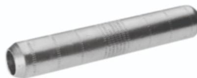
500 kcmil CU, extrémité conique, chanfrein interne, étamé, UL/CSA, 90°C, jusqu'à 35kV, code couleur BRUN, 20 ou 299 Die Index.
